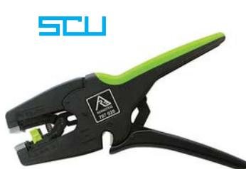
Tipo super-professionale. Per spelare cavi multipli pluriformi. Regolazione automatica delle lame in base al diametro esterno delle guaine dei cavi. Asportazione della guaina senza scalfire i conduttori. Lame di taglio in acciaio temprato. Corpo in materiale plastico rinforzato in fibra di vetro con impugnatura rivestite in morbido materiale antiscivolo, leggera e robusta per spelare conduttori rigidi, flessibili e piattine sottili. Lunghezza di spelatura regolabile da mm 3 a 18.
