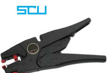
Tipo professionale. Per spelare cavi multipli pluriformi. Regolazione automatica più vite micrometrica per la profondità delle lame in base al diametro esterno delle guaine dei cavi. Asportazione della guaina senza scalfire i conduttori. Lame di taglio in acciaio temprato. Corpo in materiale plastico rinforzato in fibra di vetro leggera e robusta per spelare conduttori rigidi, flessibili e piattine sottili. Lunghezza di spelatura regolabile da mm 3 a 18.
