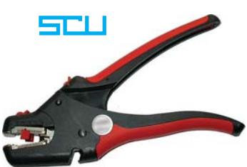
Tipo professionale. Per spelare cavi multipli pluriformi. Regolazione automatica delle lame in base al diametro esterno delle guaine dei cavi. Asportazione della guaina senza scalfire i conduttori. Lame di taglio in acciaio temprato. Corpo in materiale plastico rinforzato in fibra di vetro con impugnatura rivestite in morbido materiale antiscivolo, leggera e robusta per spelare conduttori rigidi, flessibili e piattine sottili. Lunghezza di spelatura regolabile da mm 5 a 20.
